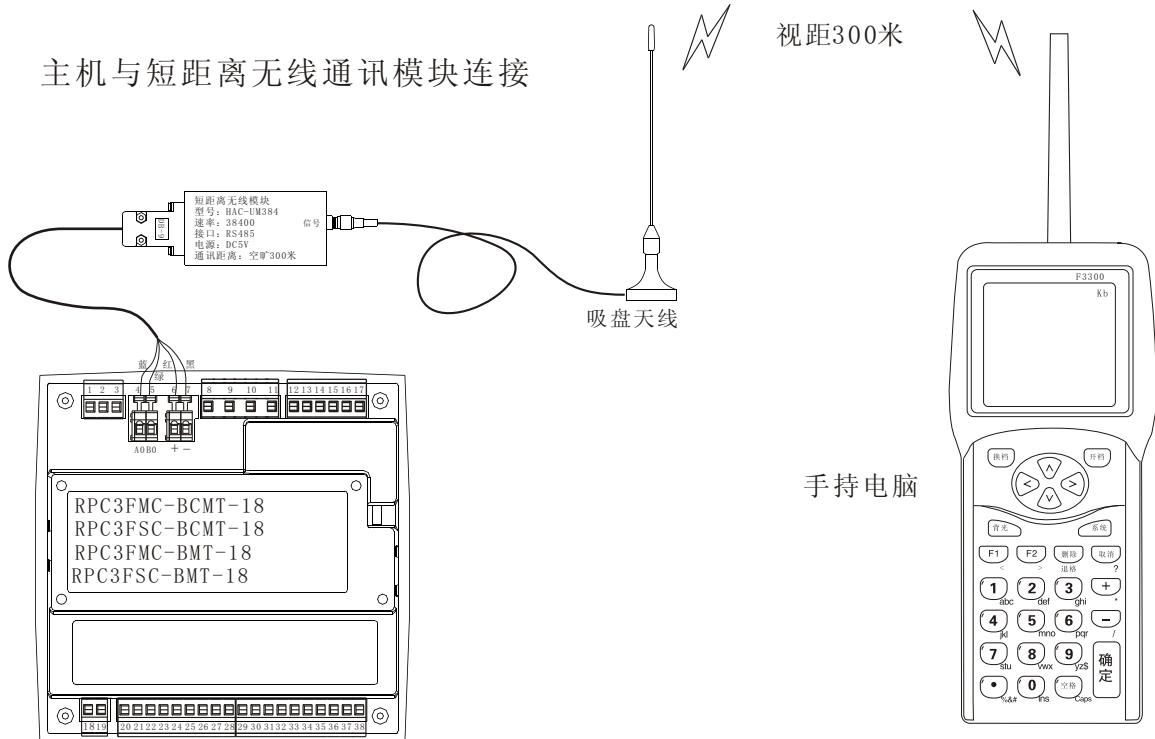
通过本手持电脑可完成查看电力参数和电容器组投切状态、修改控制参数、手动投切电力电容器组等。
