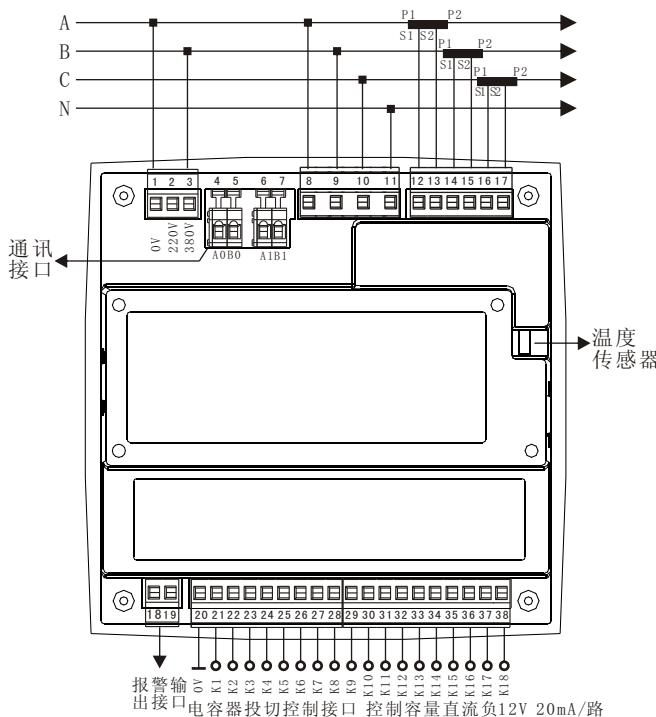
RPC3FMC型控制器接线图(静态输出)电源取220V
