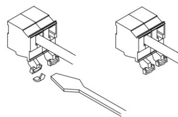
C 用大小合适的一字螺丝刀对准螺丝口顺时方向旋转
