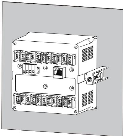
**3、回路扩展器安装：可选择导轨式安装和螺孔固定式安装**
