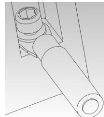
(1) 准备材料：多芯铜导线与接线鼻
