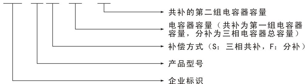
注：额定电压：S型-0.45kV，F型-0.25kV，这个电压值是指电容器的最大耐受电压，不是额定工作电压。
